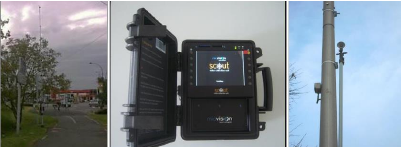
Mât de comptage avec caméra et boîtier d'enregistrement
